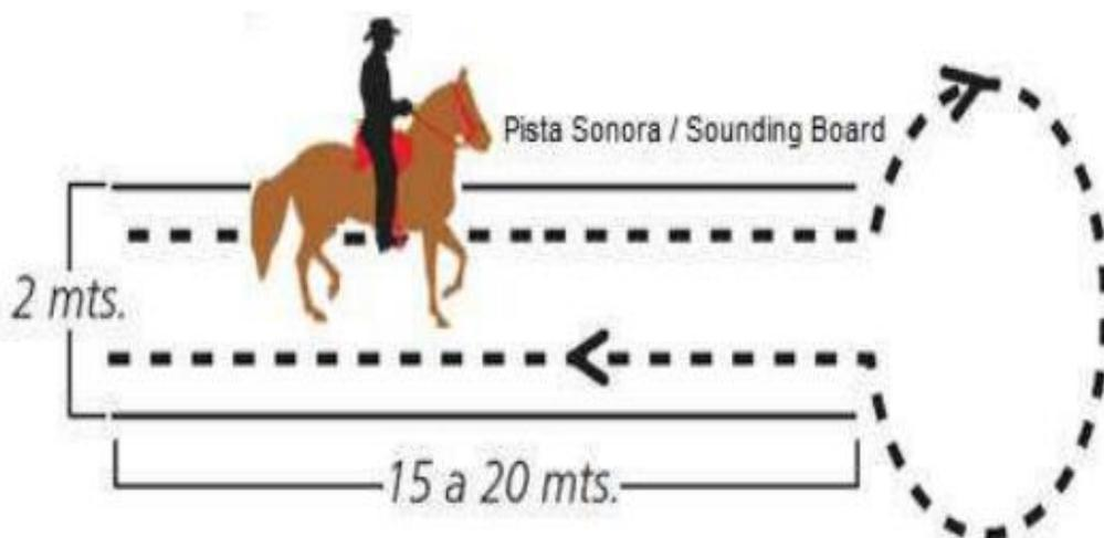
1. Sobre la tabla - La tabla deberá ser colocada al mismo nivel del terreno de la pista. Si no fuese posible entonces, deberá tener una rampa de acceso. Debe ser construida de un material sólido y compacto, en tablas de madera de buena calidad, o contraen chapado (*plywood*). Tendrá un largo mínimo de 45 pies y un mínimo de 4 pies de ancho.
