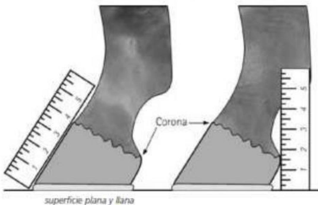
La altura del talón se determina midiendo desde la línea baja de la corona hasta el suelo, colocando la regla de manera perpendicular al suelo, según ilustración.
